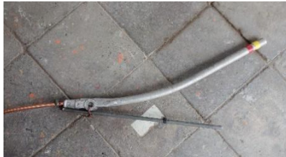
⑥ トロリー曲げベンダーをトロリーに挿入・・・
