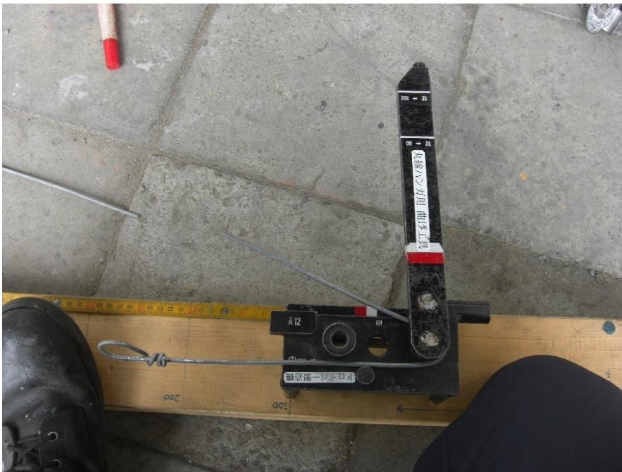
ハンドル部を上まで 持っていき ステンレス棒を曲げる。
