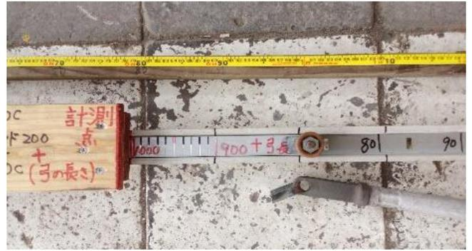
赤線表記の基準位置（鉄柱金物+180I+100C～銅線類の長さ～曲引き金物）
