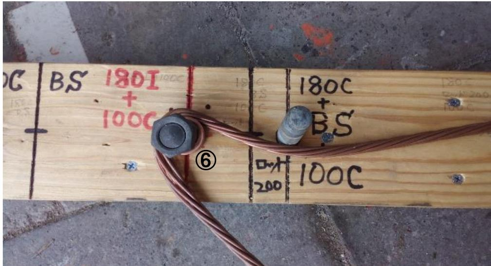
碍子部側の調整は、加工機板に書かれている部品位置のボルトに丸シンプルを設置しておく。(図13の組み合わせは180I+100Cの場合)
