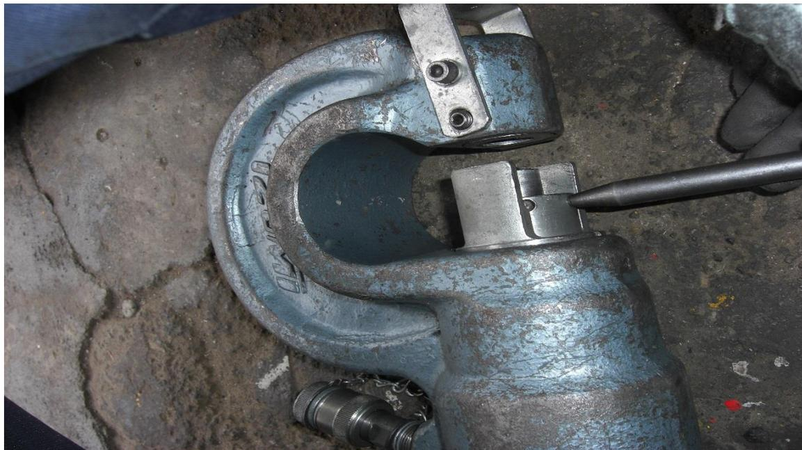
オス部の穴に専用工具Aを、入れ半時計廻りに回して緩める。
